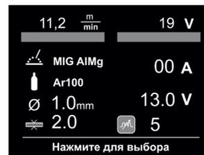
6. Установите значения индуктивности с помощью основного регулятора.
