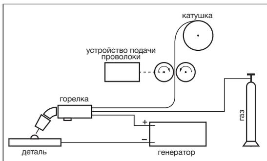
**СВАРКА С ГАЗОМ (MIG/MAG) СПЛОШНОЙ ПРОВОЛОКОЙ:**
