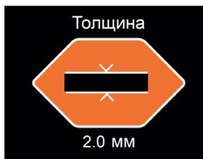
5. После введения значения толщины на экране дисплея отобразится настроенный режим сварки. Его можно скорректировать с помощью регулятора тока.
