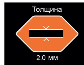
5. После введения значения толщины на экране дисплея отобразится настроенный режим сварки. Его можно скорректировать с помощью регулятора тока и напряжения.
