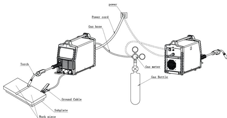
Для подключения оборудования требуется 1 фаза 220 В 50–60 Гц, автомат должен быть на 40 А при максимальном сварочном токе.
