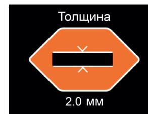
6. После введения значения толщины на экране дисплея отобразится настроенный режим сварки. Его можно скорректировать с помощью регулятора тока.
