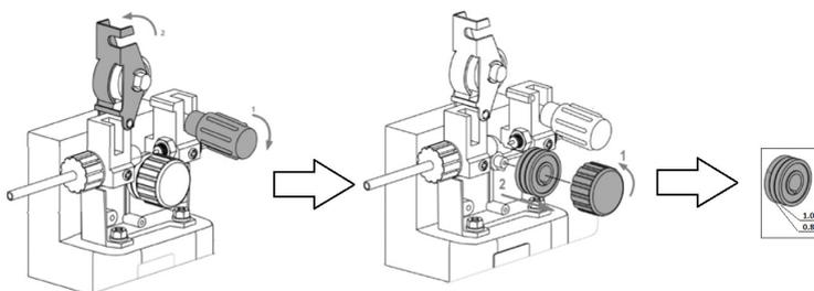
7. Откройте боковую панель аппарата и открутите стопорную гайку, чтобы установить катушку с проволокой.
