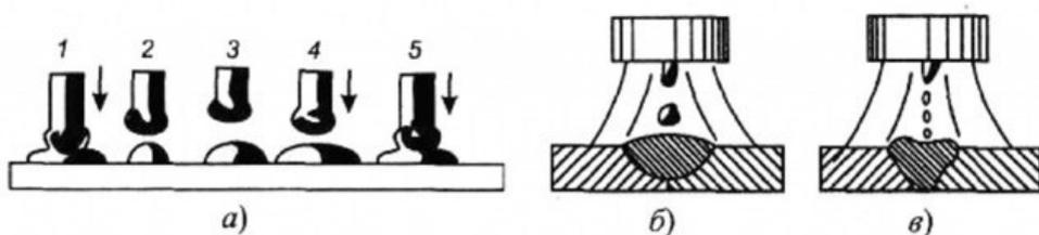
Основные формы расплавления и переноса металла: а) с короткими замыканиями; б) крупнокапельный без коротких замыканий; в) струйный.
