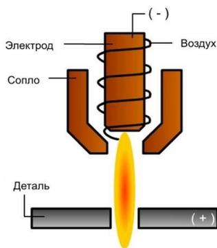
Установка воздушно-плазменной резки состоит из двух частей: плазмотрона (резака) и источника питания. Плазмотрон – основная часть и рабочий инструмент системы. Его основная функция: зажечь дугу, обеспечить превращение подаваемого воздуха в плазму (когда сжатый воздух продувается через дугу), стабилизировать и сконцентрировать плазменную струю, чтобы добиться лучшей точности и скорости при резке.
