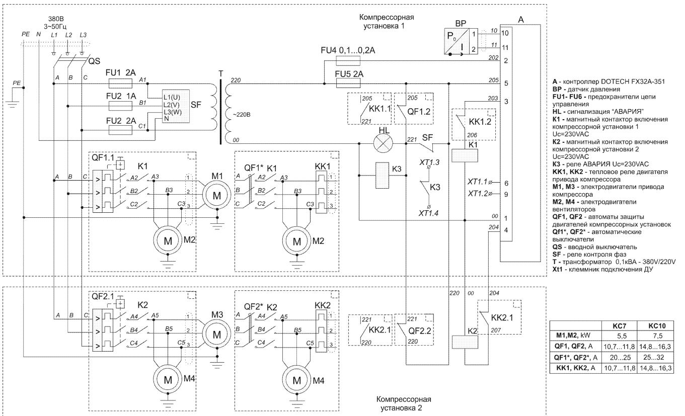
Рисунок Б.2 – Схема электрическая принципиальная компрессорных установок
