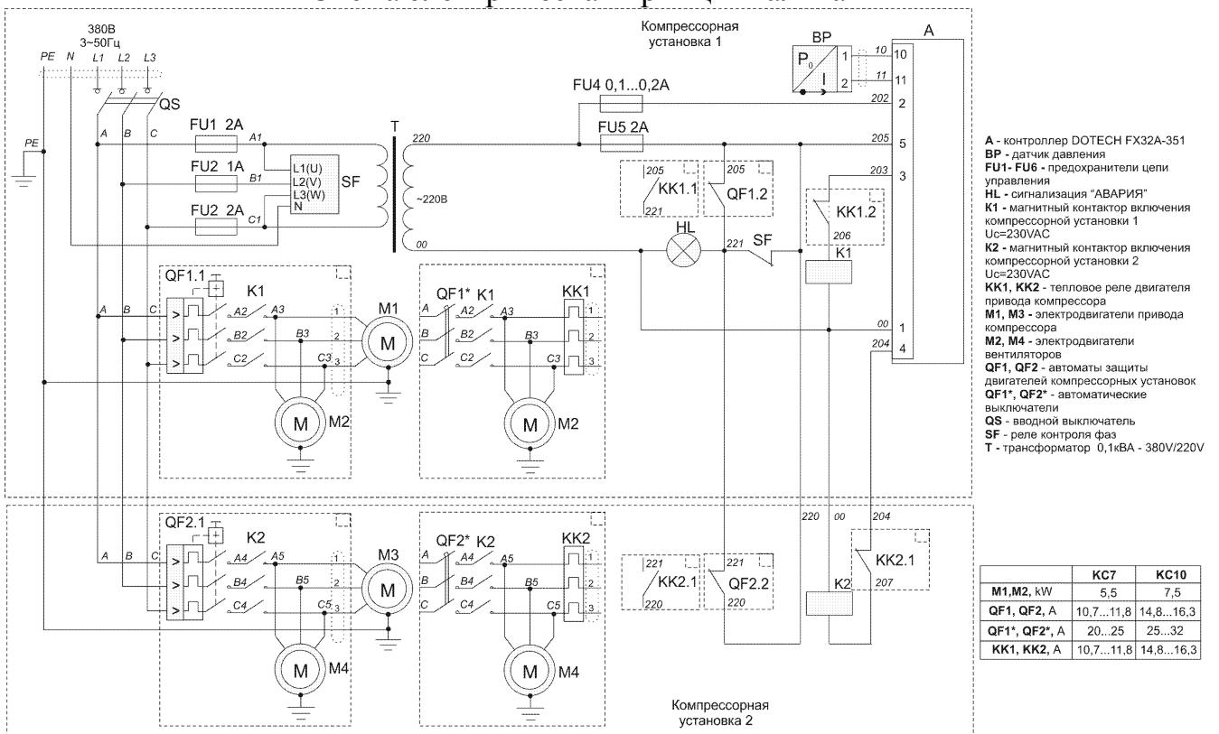
Рисунок Б.1 – Схема электрическая принципиальная компрессорных установок
