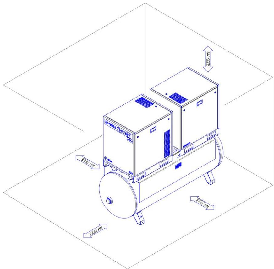
Рисунок 5 – Расстояние до стен
