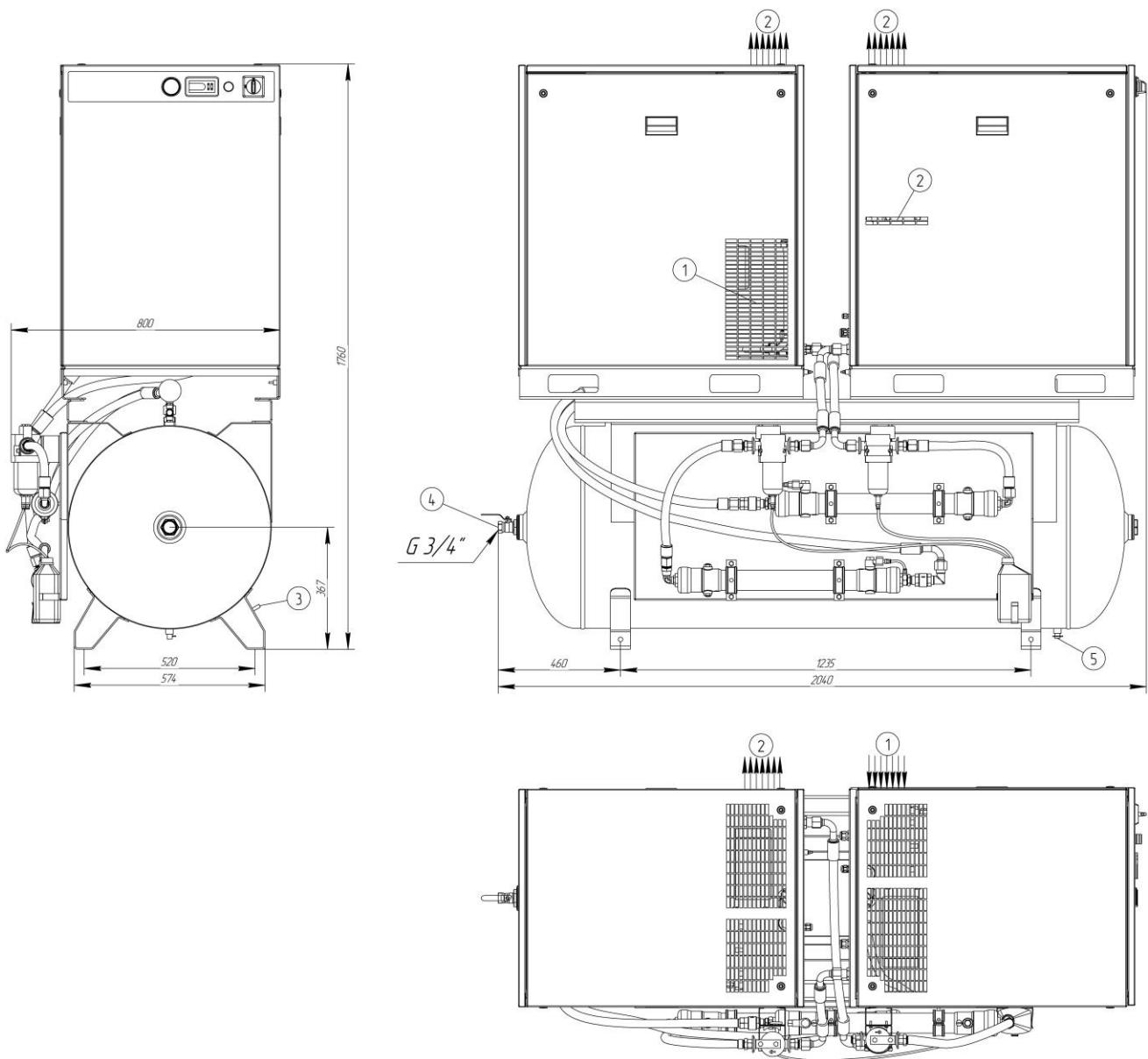
**1** – забор воздуха; **2** – выброс теплого воздуха; **3** – болт заземления; **4** – выход сжатого воздуха; **5** – кран слива конденсата.
