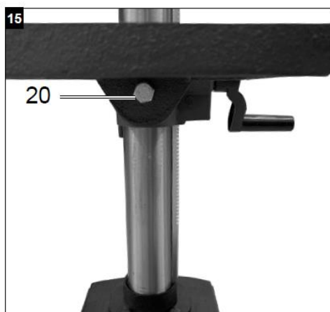
Установка угла наклона сверильного стола. Рис. 1, 15
