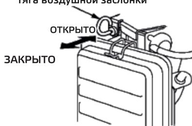
В некоторых случаях применения двигателя предпочтительнее использовать дистанционно установленную тягу воздушной заслонки, нежели установленную на двигателе. Обратитесь к инструкциям, предусмотренным производителем оборудования.
