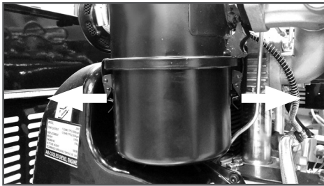
Рис. 16 Снятие стакана воздухоочистителя
