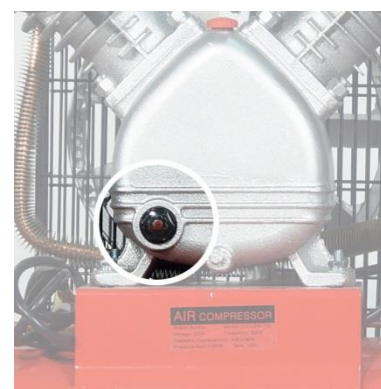
1 – маслозаливное отверстие 2 – масляный сапун
