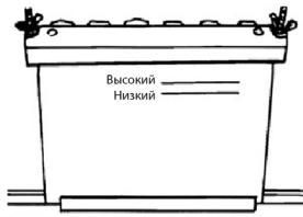
При недостаточном уровне электролита пусковой ток стартера будет слишком низким и он не сможет работать. Уровень электролита должен быть между отметками верхнего и нижнего уровня.
