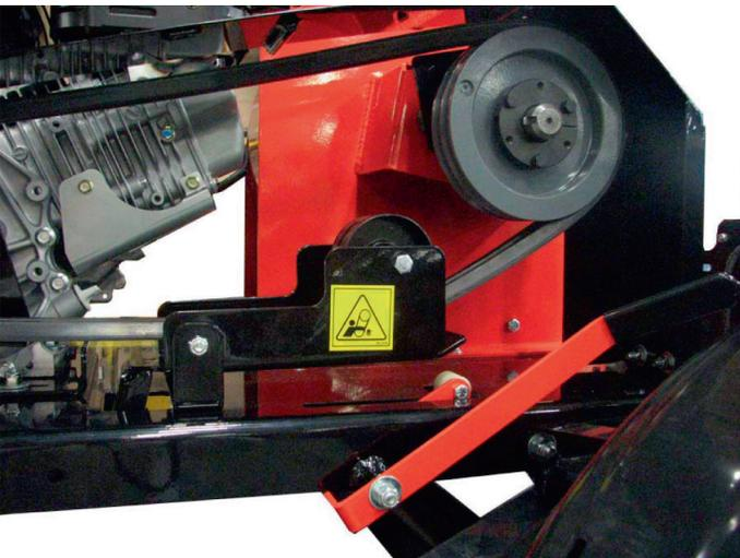
Рис. 5.4. Ручка включения в положении ИЗМЕЛЬЧЕНИЕ
