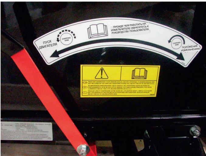
Рис. 5.3. Ручка включения в положении START
