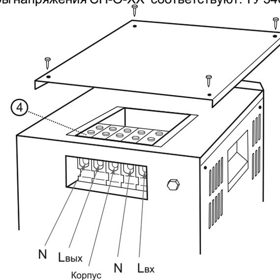
Рис. 16 Вид сзади со снятой верхней крышкой
