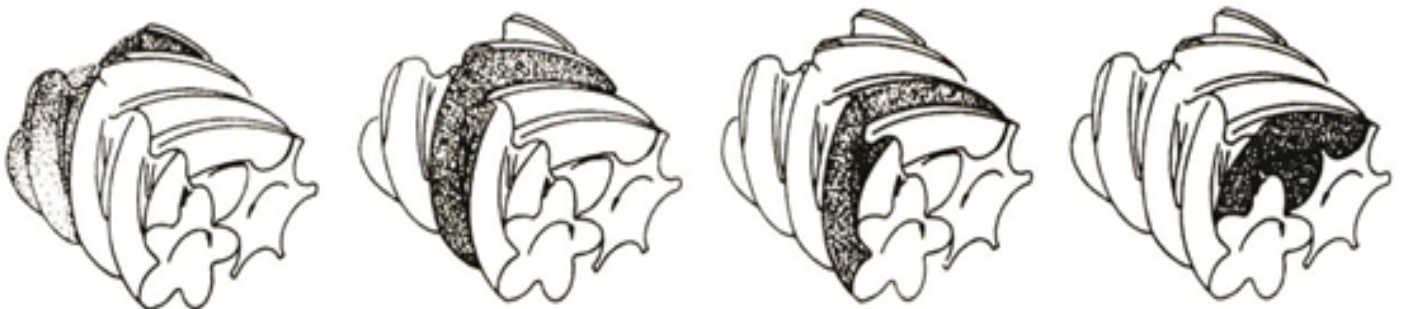
1. Процесс засасывания 2. Процесс запечатывания и доставки 3. Сжатие и процесс впрыска масла 4. Процесс выхлопа
