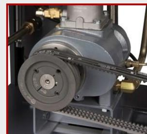
ведущий и ведомый. При их вращении происходит движение воздуха от всасывающей стороны к нагнетающей с одновременным уменьшением объема межроторных полостей (сжатие). Зазор между роторами уплотняется находящимся в корпусе
