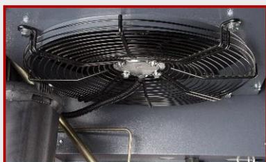
Для охлаждения сжимаемого винтовым компрессором воздуха его пропускают через радиатор, который обдувается вентилятором. Температура сжатого воздуха на выходе компрессора, как правило, превышает температуру окружающей среды не более, чем на 20-30 °С.
