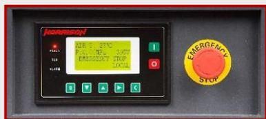
Всей работой компрессора Harrison управляет контроллер. Он отображает на дисплее информацию о состоянии сжатого воздуха в соответствии с предварительно заданными параметрами. Контроллер сохраняет и отображает общее время работы компрессора, время его работы под нагрузкой, без нагрузки и время использования различных расходных материалов. Компьютер имеет разъём для дистанционного управления.
