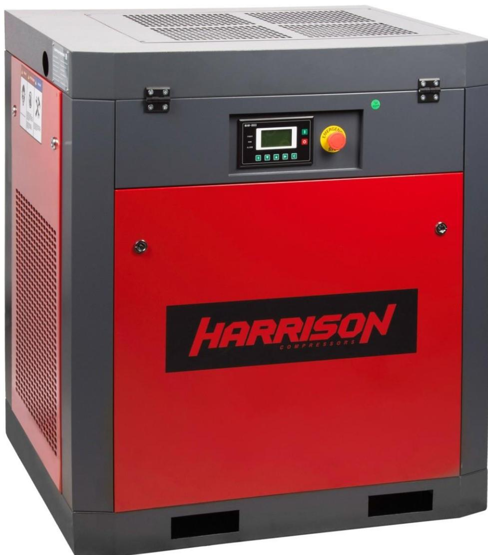
**ВИНТОВОЙ КОМПРЕССОР С РЕМЕННЫМ ПРИВОДОМ**
