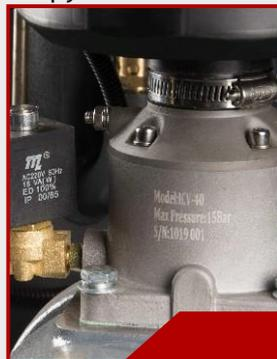
Запорный элемент всасывающего клапана имеет вид поворотного (заслонки) или поступательнодвигающегося диска с уплотнением. Положение запорного элемента изменяется под действием сжатого воздуха, подаваемого во внутренний или внешний пневмоцилиндр из масляного резервуара через управляющий электромагнитный клапан.
