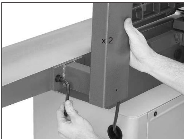
Рис. 14 Установка подставки для панели управления
