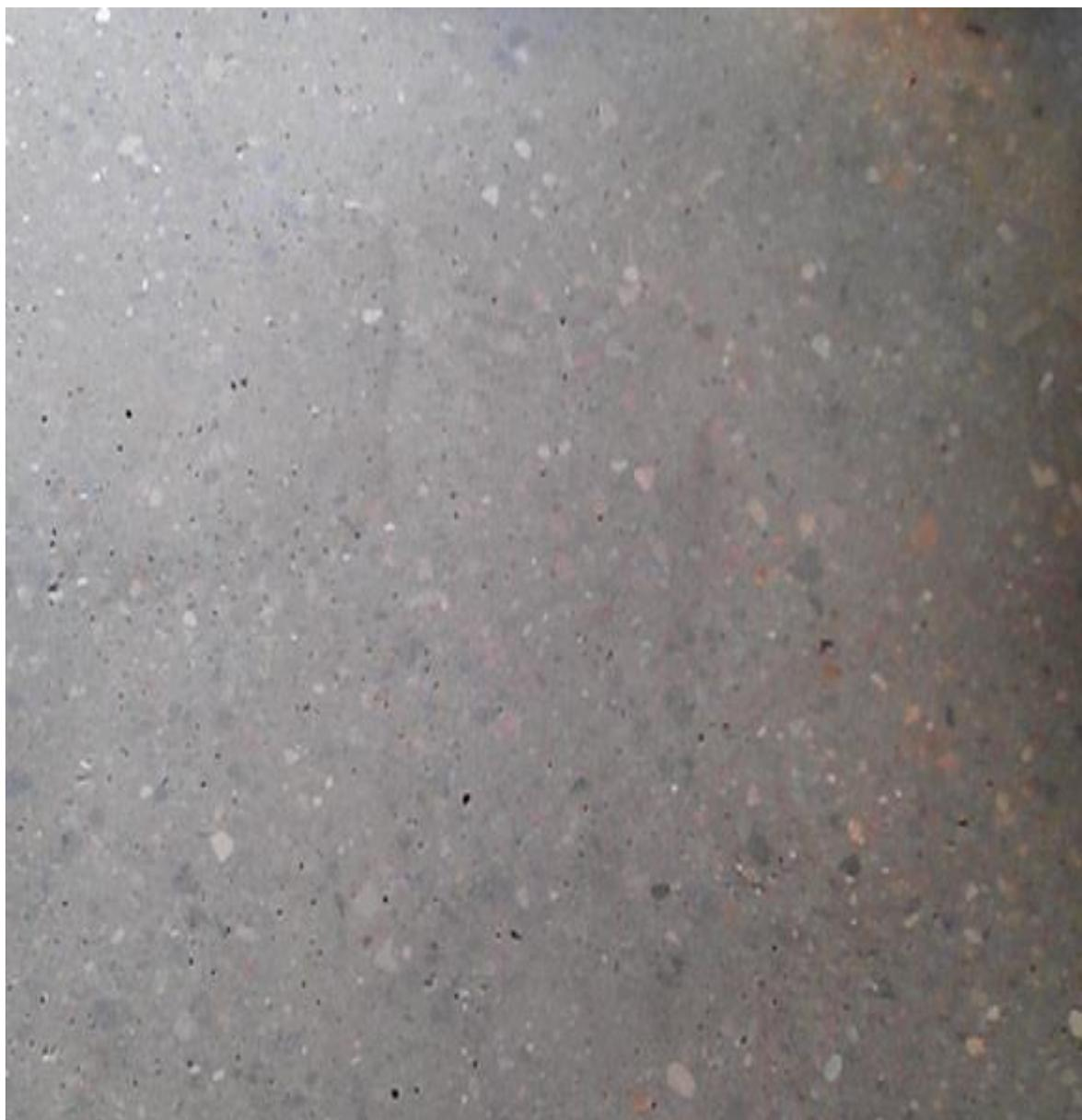
3. Заканчиваем полировку бетона полировальным франкфуртом переходом №3 арт. 110447 или 127337) зернистостью 5/3 мкм (3000 grit).
