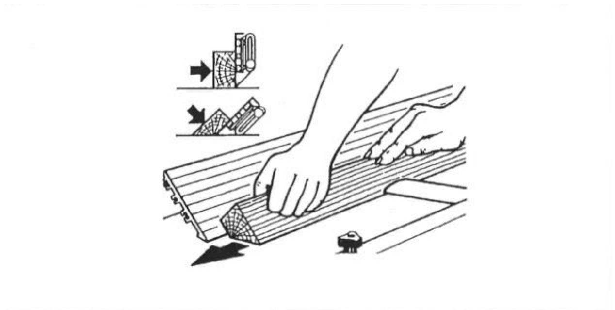
затем снова затяните ручки и включите машину. Поднесите край заготовки к линейке.
