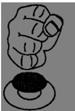
Е-стоп Кнопка аварийная кнопка используется в случае чрезвычайной ситуации. Нажав ее полностью заблокируется работа станка. В случае повреждения или ошибок немедленно нажмите аварийного выключения! Чтобы восстановить кнопку поверните верхнюю часть.
