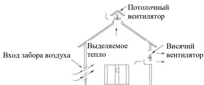
При установке трубы для отвода воздуха оставьте немного места для присоединения брезентового воздуховода с целью облегчения технического обслуживания (достаточное пространство для снятия защитной панели и других деталей компрессора при очистке охладителя).
