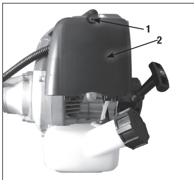
Рис. 14 Снятие крышки воздушного фильтра ТА2
