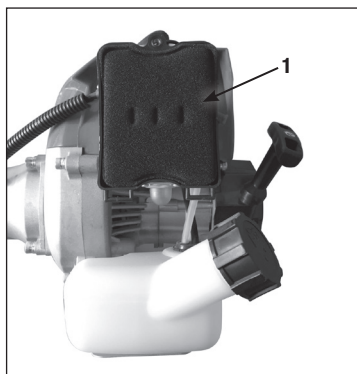
Рис. 15 Обслуживание воздушного фильтра ТА2
