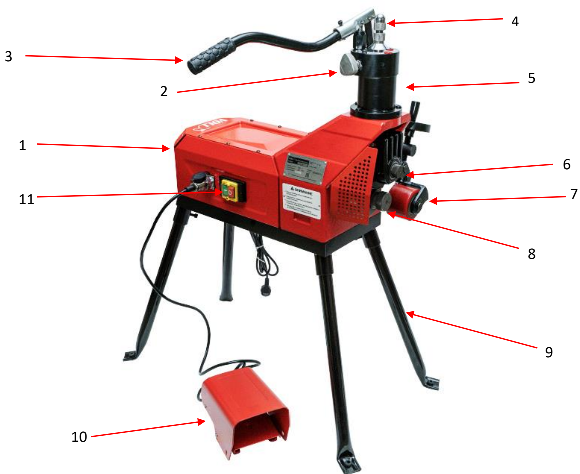
Рис. 1 Устройство желобонакатного станка
