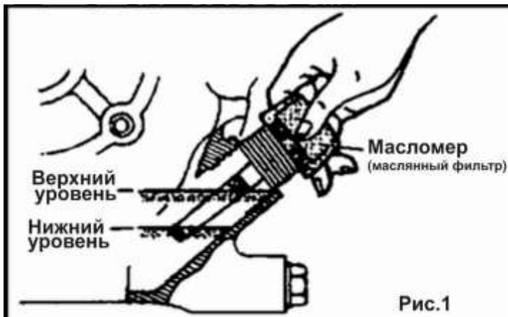
1-5. Снимите пробку на блоке вибратора и проверьте уровень масла. Убедитесь, что при проверке виброплита установлена ровно. Уровень масла должен доходить до самой пробки. Замену масла необходимо производить каждый месяц или через каждые 200 часов работы.
