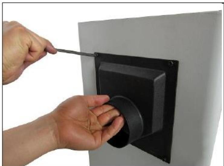
1. Установить патрубок аспирации опилок на отверстие отвода опилок на боковой стенке тумбы.
