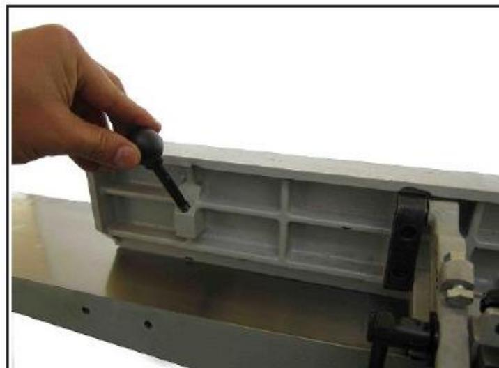
Рис. 12. Установка рукояток наклона параллельного упора
