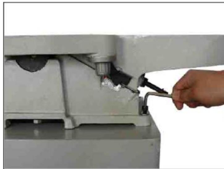
Рис. 4. Установка переднего крепёжного болта
