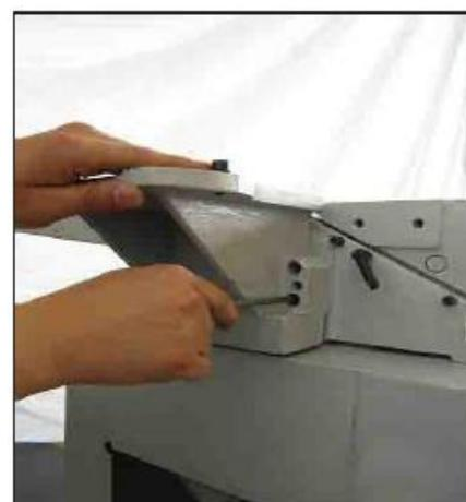
Рис. 9. Собранный кронштейн крепления каретки
