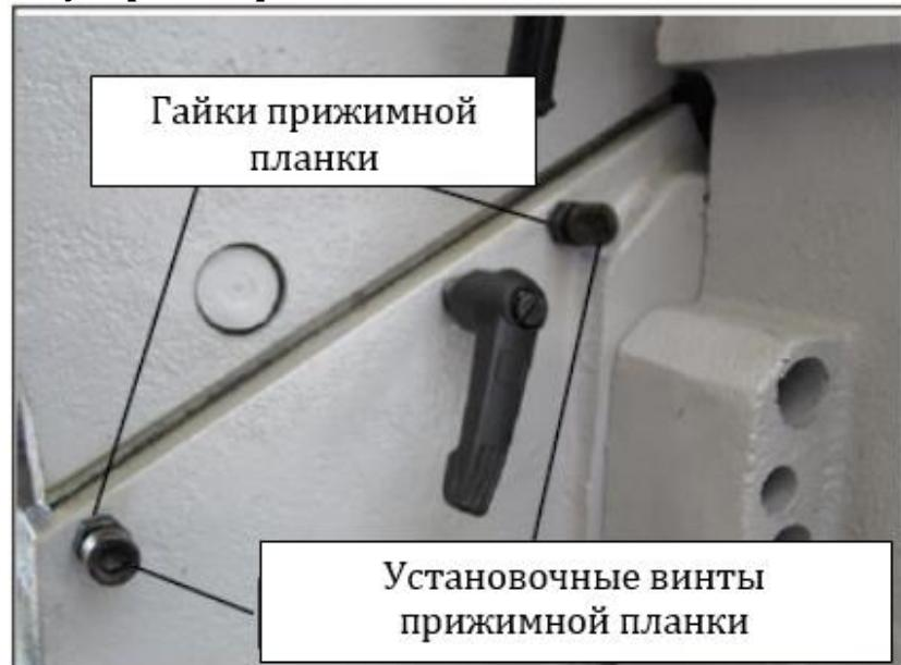
1. Ключом 10 мм ослабить две гайки прижимной планки выводного стола сбоку на основании фуговального станка (рис. 30).
