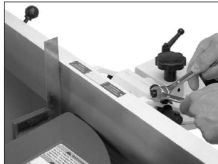
Рис. 27. Регулировка параллельного упора на угол 90°
