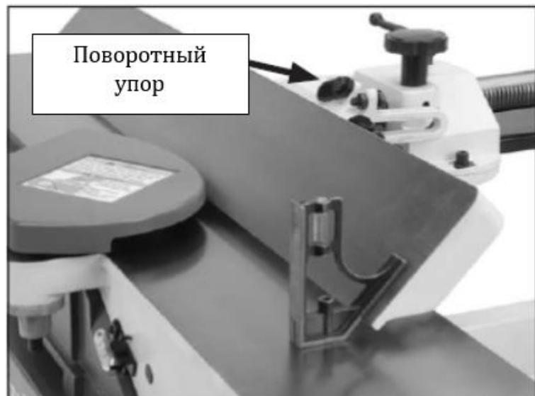
Рис. 28. Регулировка параллельного упора под угол 45° наружу
