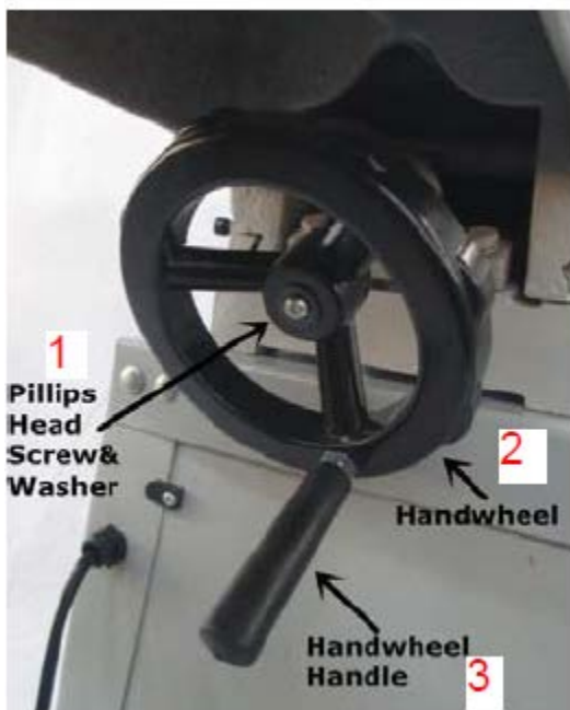
Рис. 21: 1 – винт с крестообразным шлицем, с шайбой, 2 – маховичок, 3 – рукоятка маховичка
