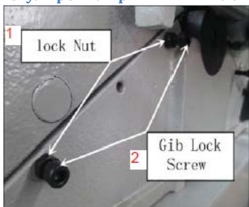
Рис. 20: 1 – контргайка, 2 – винт фиксации прижимной планки направляющей
